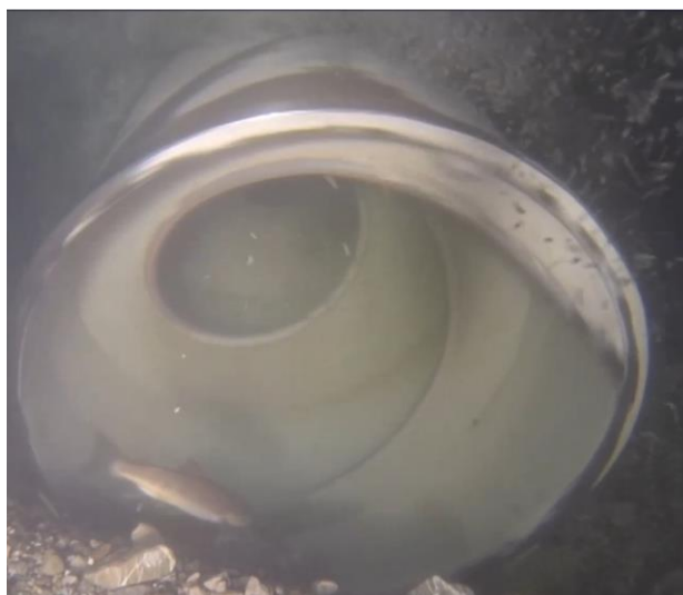
Obr. 41: Detail turbíny, prostřední část je prodloužená a slouží pro protiproudou migraci.
