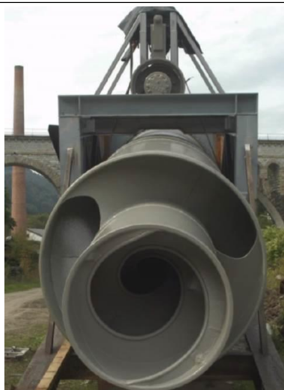
Obr. 41: Detail turbíny, prostřední část je prodloužená a slouží pro protiproudou migraci.
